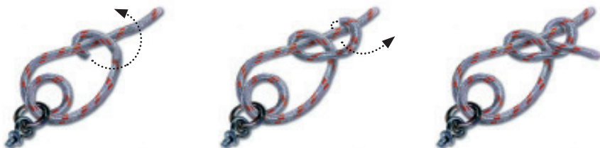
Ulkosorkka • Dubbelt halvslag on eget part • Two Half Hitches Zwei halbe Schlege • Dubbele halve steek
