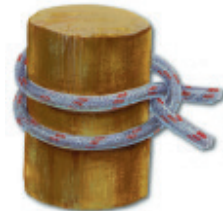
Siansorkka • Dubbelt halvslag • Clove Hitch • Webeline Stek • Mastworp
