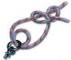
Ulkosorkka • Dubbelt halvslag on eget part • Two Half Hitches Zwei halbe Schlege • Dubbele halve steek
