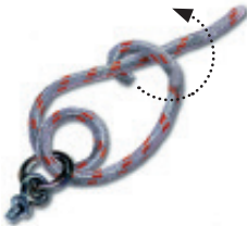
Ulkosorkka • Dubbelt halvslag on eget part • Two Half Hitches Zwei halbe Schlege • Dubbele halve steek
